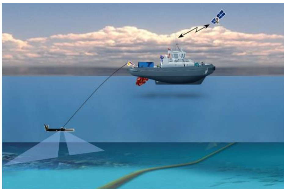
Рис. 1. Сканирование дна буксируемым гидролокатором
