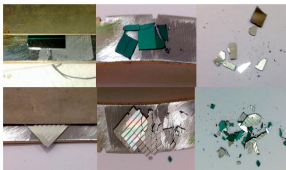
Рис. 1. Разрушение кремниевого кристалла при деформации в случае, когда кристалл расположен между двумя деформируемыми плоскостями
