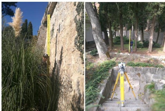
Рис.1. Нивелирование цифровым нивелиром SOKKIA SDL1X и инварной рейкой BIS30
