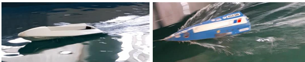
Рис. 2. – Протяжка моделей в опытовом бассейне
